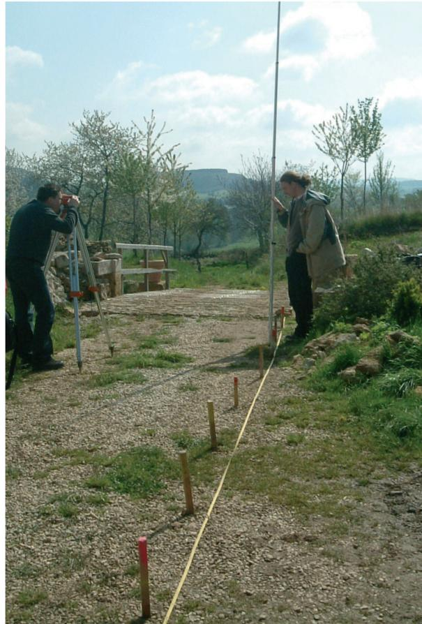
FIG. 8 – Photographie illustrant le principe de mesures topographiques. Un expérimentateur, à gauche, mesure à l'aide d'une visée, une mire tenue verticalement par un autre expérimentateur, à droite de la photographie. Deux valeurs en haut et en bas de la valeur principale sont aussi relevées afin de vérifier en faisant leur moyenne que la valeur centrale est bien correcte. Au final, nous obtenons la hauteur relative de la visée par rapport à l'endroit où est positionnée la mire.
