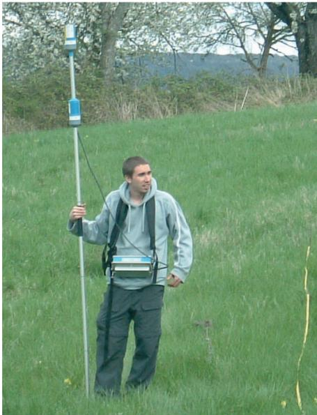
FIG. 10 – Expérimentateur réalisant une mesure magnétique. Le déplacement se fait suivant une droite (profil). Une mesure est effectuée pour un intervalle de distance donné (1 m dans notre cas). Il faut bien faire attention à orienter l'antenne vers le Nord et ne porter aucun objet métallique au cours de l'expérience pour ne pas fausser les mesures.
