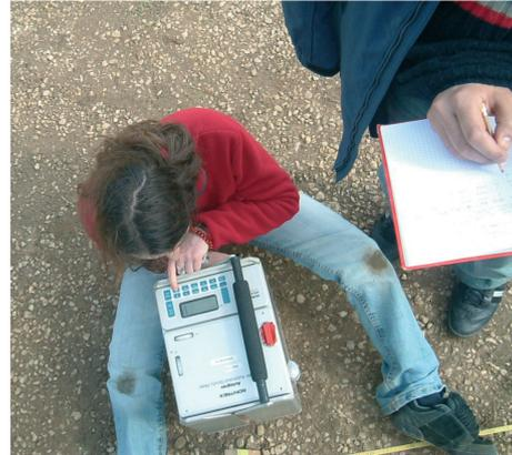
FIG. 6 – A gauche : schéma illustrant le principe de fonctionnement du gravimètre relatif thermostaté Scintrex utilisé. L'allongement du ressort à quartz sous l'effet de la gravité  $g$  modifie l'intensité du courant qui circule à travers l'appareil. Cette intensité est traduite par l'appareil en terme de gravité. A droite : photographie des expérimentateurs effectuant une mesure gravimétrique. L'appareil doit rester horizontal pendant toute la durée de la mesure.
