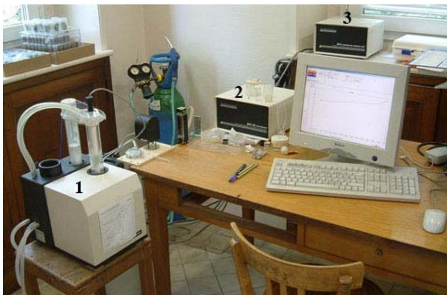
Fig. 3.1 : Dispositif expérimental d'analyse thermomagnétique, avec le boîtier contenant la bobine (1), le susceptibilimètre *KLY-3S* (2) et l'unité de commande du four *CS-3* (3).
